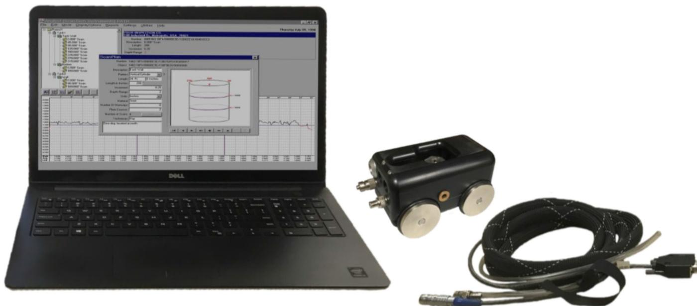
O scanner H3 é um scanner portátil manual compacto para mapeamento ultrassônico de corrosão. Este scanner é extremamente resistente e vedado para minimizar a manutenção. O sistema inclui uma recirculação de acoplante avançado que reduz o ruído e aumenta a qualidade do sinal. Ele também inclui um adaptador receptor de linha que faz interface com muitos instrumentos ultrassônicos populares. A sapata da sonda é um design flutuante de baixo atrito, que reduz o desgaste e a manutenção.
