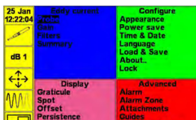
Menu simples mostrando quatro teclas programáveis pelo usuário e uma tecla para exibição de "último item usado"
