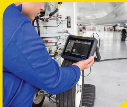
A solução inovadora do detector de falhas por ultrassom WAVE é adequada para várias aplicações industriais, desde a fabricação aos serviços de engenharia.
